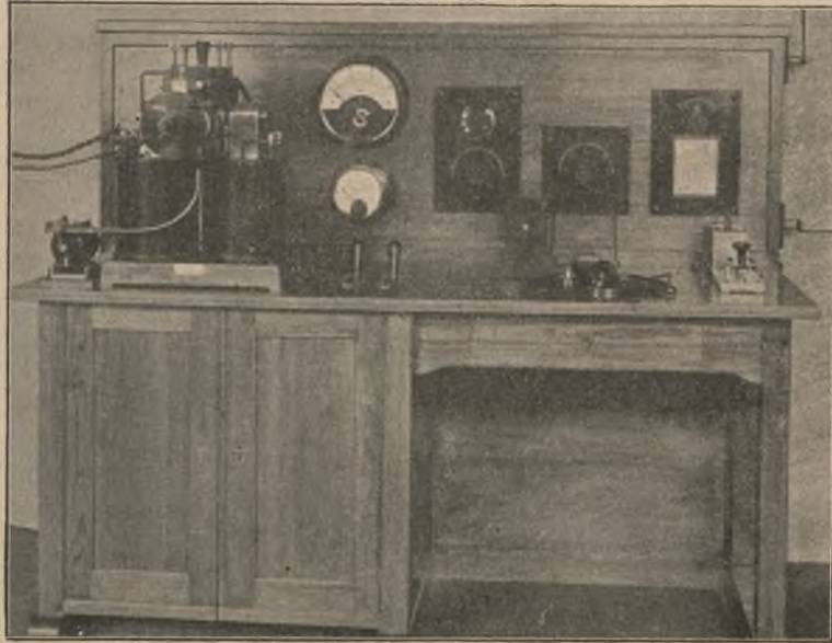
Abb. 2. Station für drahtlose Telephonie (System Poulsen). Sende- und Empfangseinrichtung.
