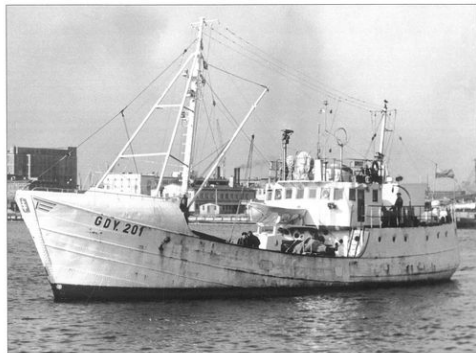
"Birkut" (GDY 201) ługotrawler typu B-11 przebudowany na statek badawczy MIR
