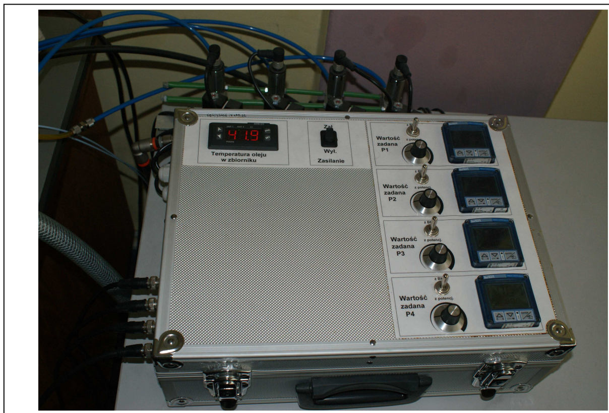
Rys. 98 Widok układu regulacji ciśnienia w łożysku, cztery niezależnie sterowane kanały
