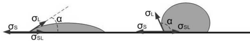
Rycina 1. Wpływ obecności surfaktantów na proces zwilżania modelowej powierzchni rdzenia tabletki. Po lewej dyspersja dobrze zwilżająca, po prawej słabo zwilżająca rdzeń. Oznaczenia jak w tekście (8).
