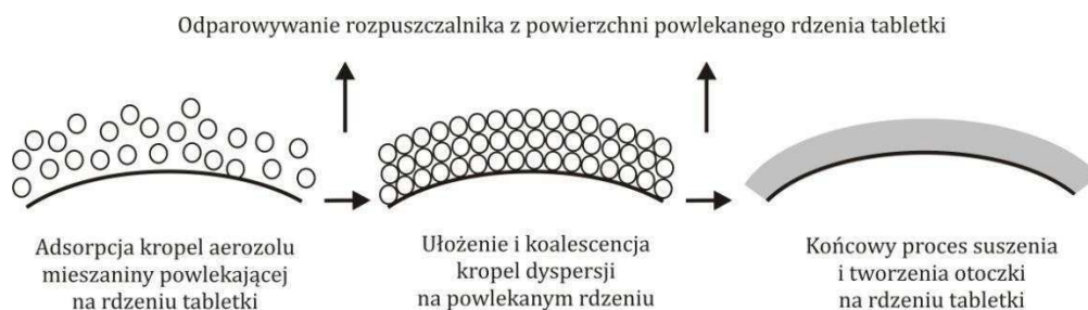
Rycina 2. Mechanizm tworzenia polimerowej otoczki w procesie nanoszenia mieszaniny powlekającej na rdzeń tabletki (10).
