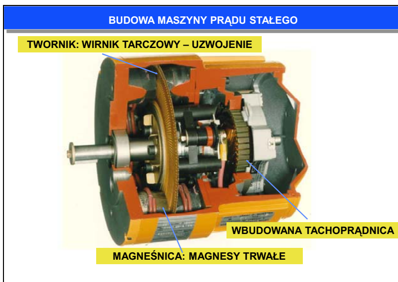
Rys. 5.12. Silnik tarczowy prądu stałego z magnesami trwałymi
