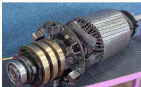
uzwojenie wirnika – pierścieniowe (z rdzeniem)
