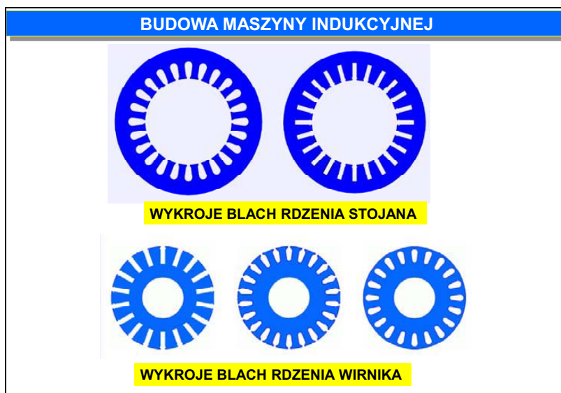
Rys. 7.2. Wykroje blach rdzeni maszyny indukcyjnej [63]
