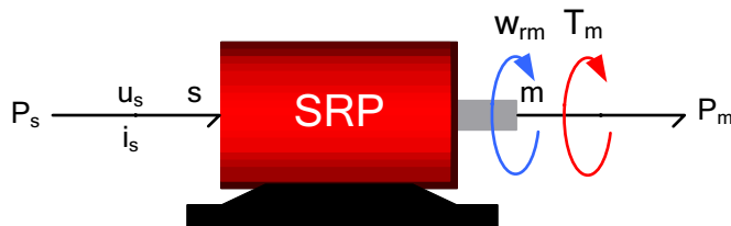
Rys. 8.44. Silnik reluktancyjny przełączalny – dwuwrotowy przetwornik elektromechaniczny: wrota (zaciski) obwodu stojana „s” – dopływ energii elektrycznej przetwarzanej na energię mechaniczną, wrota układu (obwodu) mechanicznego „m” – odpływ energii mechanicznej
