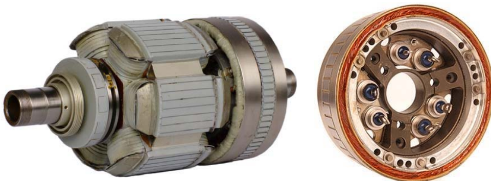
Rys. 3.8. Wirnik nowoczesnego trójstopniowego generatora synchronicznego: a) na wspólnym wale znajdują się od lewej: wzbudzenie generatora z magnesami trwałymi, wzbudzenie głównego generatora, twornik wzbudnicy, b) twornik wzbudnicy z wirującym prostownikiem diodowym [11]
