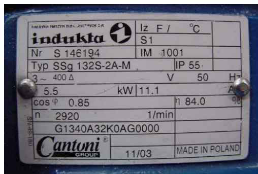
tabliczka znamionowa silnika klatkowego
