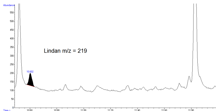
Rysunek 17. Chromatogram SIM ( m/z = 219 ) uzyskany w trakcie analizy próbki miodu wielokwiatowego z wykorzystaniem opracowanej metodyki DLLME-GC-MS, w którym wykryto pozostałość lindanu ( t_R=10,602 min)
