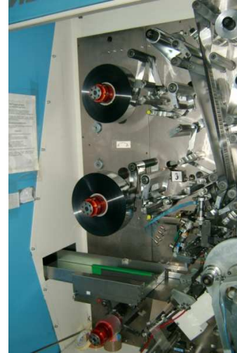
Rys. 2.6. Ilustracja procesu tworzenia zwijek: a) widok szpul metalizowanej folii, b) nawijarka
