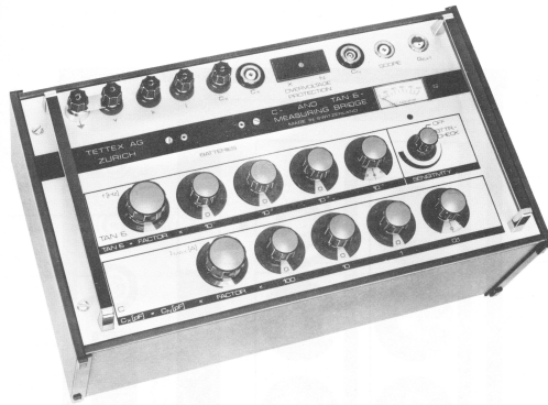
Rys. 2.16. Przyrządy do pomiarów pojemności C i wartości \text{tg}\delta : a) mostek transformatorowy firmy Tettex typ 2805 [92], b) mostek cyfrowy firmy Tettex typ 2816 [92]
