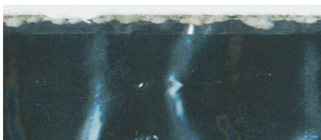
Rys. 7.10. Fragment folii zwijki kondensatorowej z uszkodzoną podczas iskrzenia krawędzią od strony metalizacji czoła
