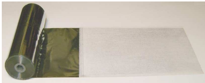
Rys. 2.7. Widok folii z usuniętą warstwą metalizacji końca zwijki
