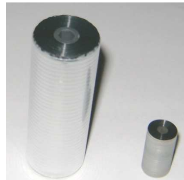
Rys. 2.8. Gotowe zwijki po nawinięciu: zwijka na trzpieniu izolacyjnym (po lewej), zwijka bez trzpienia przeznaczona do spłaszczania (po prawej)
