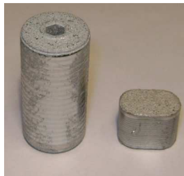
Rys. 2.10. Proces metalizacji czoł zwijek: a) przygotowanie pakietu zwijek, b) napyłanie metalu roztopionego w łuku elektrycznym na czoła zwijek, c) pakiet zwijek po metalizacji, d) gotowe zwijki
