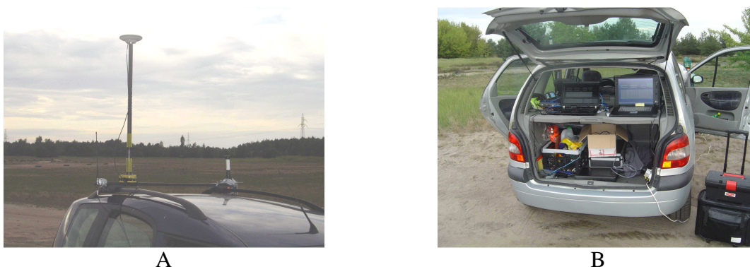
Rys. 8.21. Testy naziemne urządzeń GPS: zestaw ruchomy zamontowany na samochodzie (A); stanowisko rejestrujące (B)
