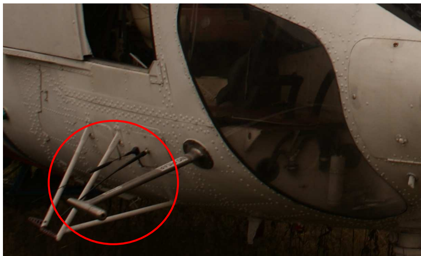
Rys. 7.10. Miejsce montażu anteny zapasowej sieci radiowej na pokładzie śmigłowca
