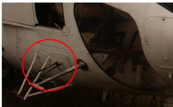
Rys. 7.6. Miejsce montażu anteny GPS (A) oraz anteny modemu radiowego (B)
