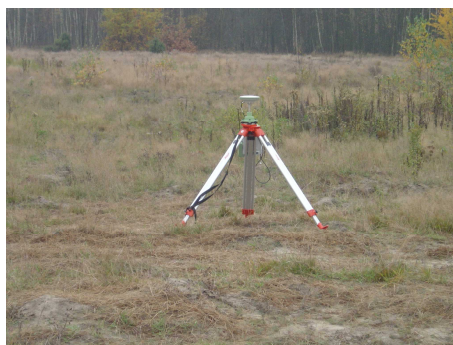
Rys. 8.23. Stacja referencyjna (baza) na poligonie w Zielonce w przyjętej metodzie pomiaru (RTK)
