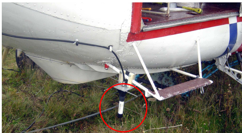
Rys. 7.9. Miejsce montażu anteny radiowej na pokładzie śmigłowca
