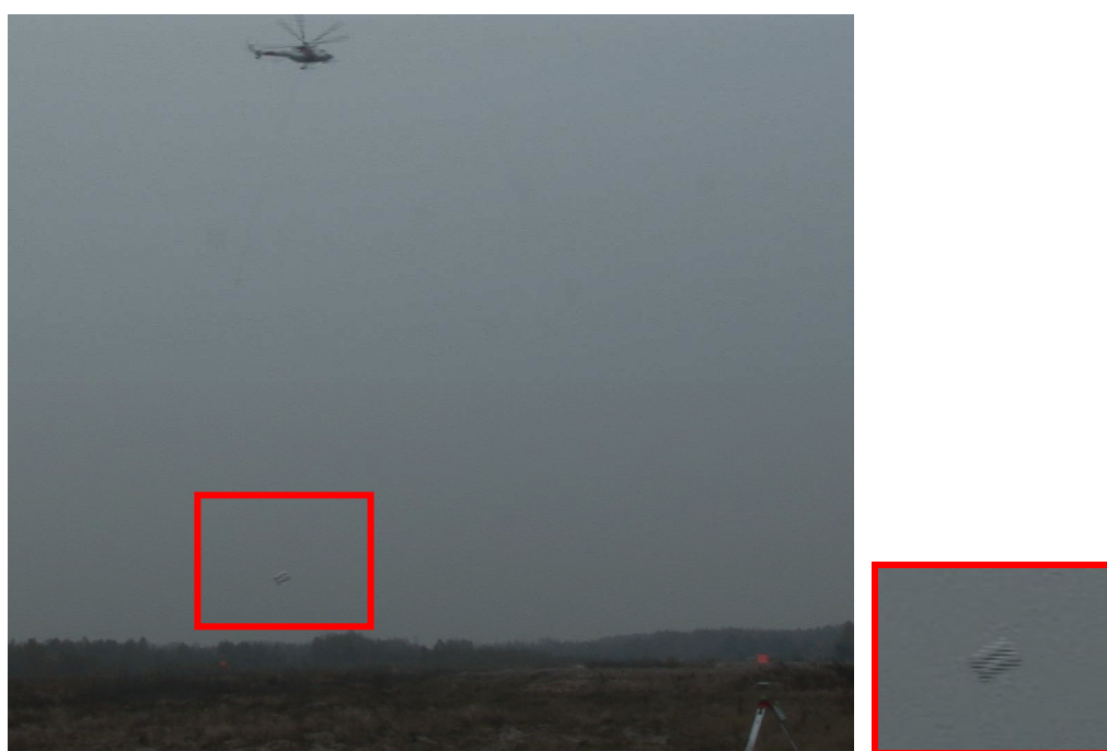
Rys. 8.32. Kształt kapsuły wodnej podczas próby Lot3b. Uwidacznia się tu niewłaściwa konstrukcja worka – woda ma możliwość przemieszczania się w obszarze worka (worek za bardzo spłaszczony), co wpływa na zmianę wartości współczynników aerodynamicznych kapsuły (kapsuła leciała od strony lewej do prawej)
