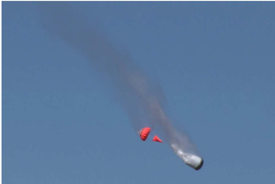
Rys. 8.38. Ubytek wody z kapsuły w próbie Lot2d
