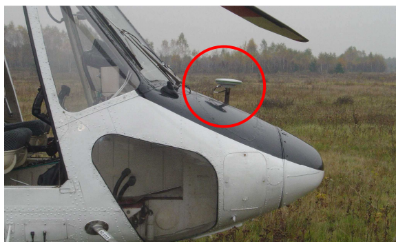
Rys. 7.6. Miejsce montażu anteny GPS (A) oraz anteny modemu radiowego (B)
