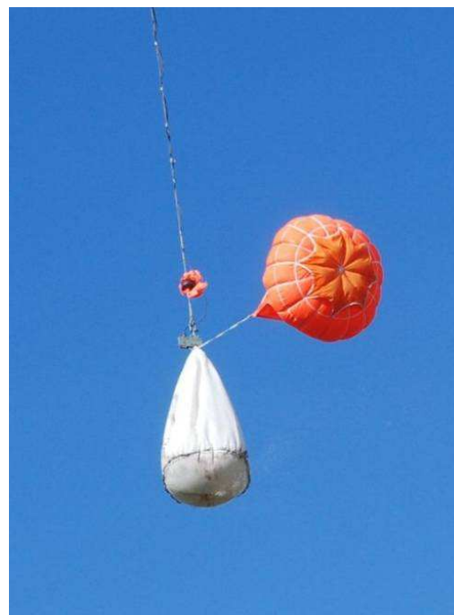
Rys. 8.33. Śmigłowiec podczas lotu z kapsułą wodną – A, kapsuła wodna ze spadochronem stabilizującym – B
