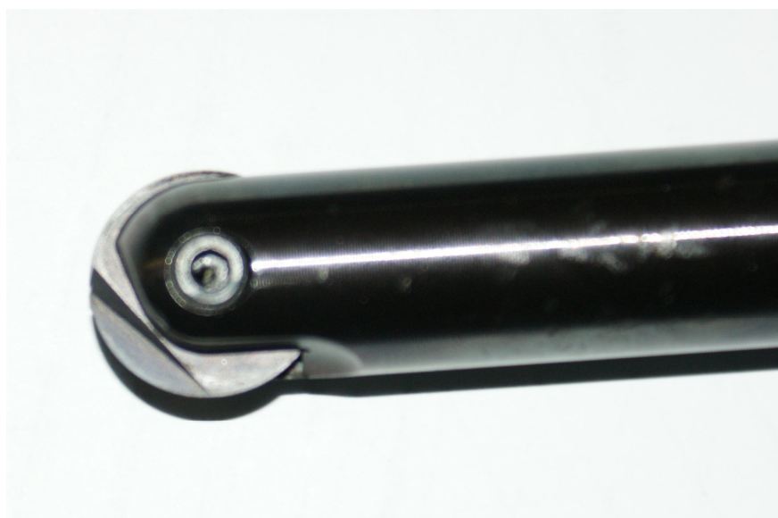
Rys. 41. Końcówka freza FETTE R.16.016AN160
