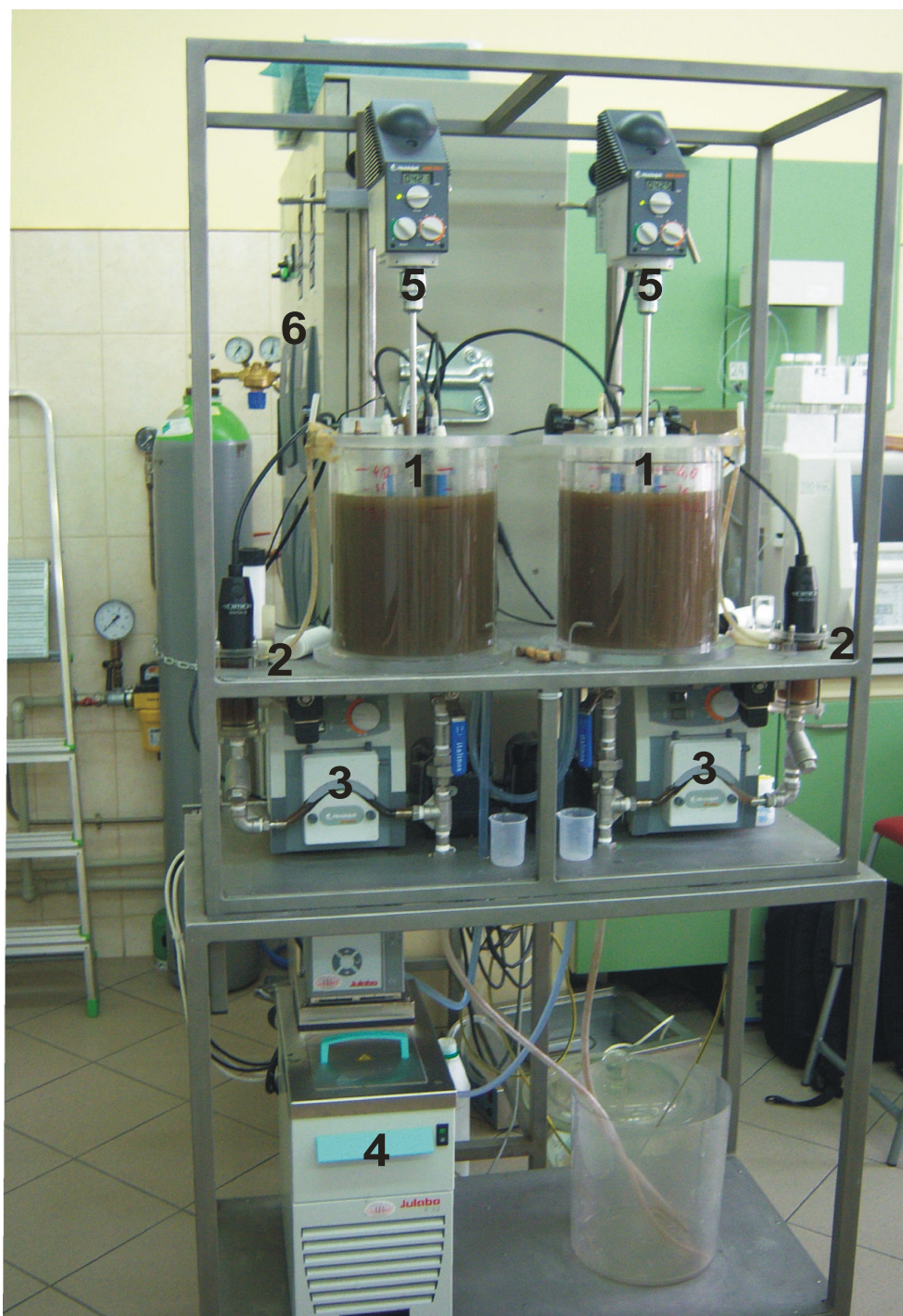
Fot. 6.6. Stanowisko laboratoryjne do pomiaru szybkości procesów biochemicznych w komorach osadu czynnego. 1-reaktory osadu czynnego, 2-naczynia pomiarowe OUR, 3-pompy perystaltyczne, 4- łaźnia wodna z chłodziarką, 5- mieszadła mechaniczne, 6- szafa sterownicza wraz z miernikami wieloparametrowymi.
