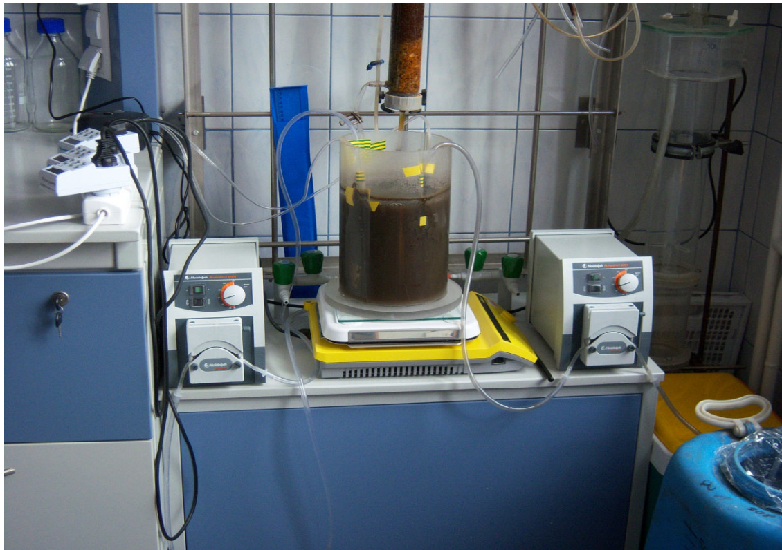
Fot. 6.5. Laboratoryjny model układu SBR (fot. własna).
