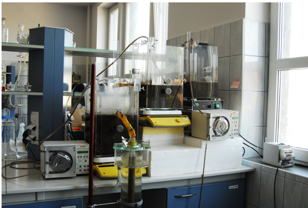
Fot. 6.4. Laboratoryjny model układu A2/O (fot. własna).
