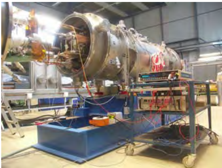
System pomiarowy do diagnostyki uzwojeń magnesów nadprzewodzących akceleratora cząstek w GSI Helmholtz Centre for Heavy Ion Research GmbH, Darmstadt Fot. arch. autora
