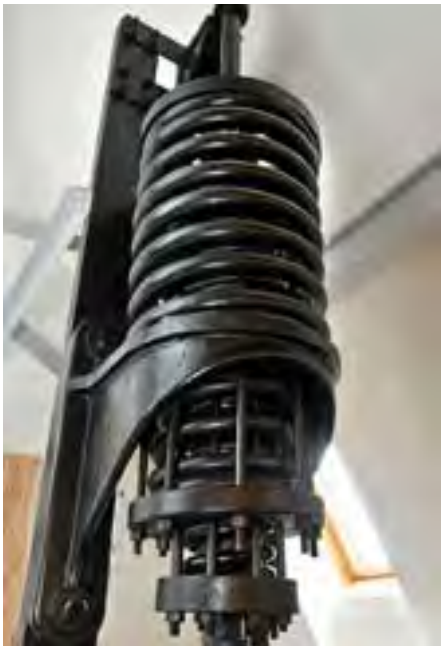
Zachowany, oryginalny układ sprężyn, który był źródłem napędu zegara wieżowego. Mechanizm obecnie znajduje się na Wydziale Architektury Fot. Krzysztof Krzempek
