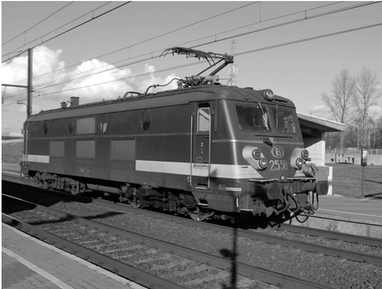
Fot. 3.7. Lokomotywa dwusystemowa pracująca przy napięciu 3000 V lub 1500 V DC (fot. R. Delaedt)
