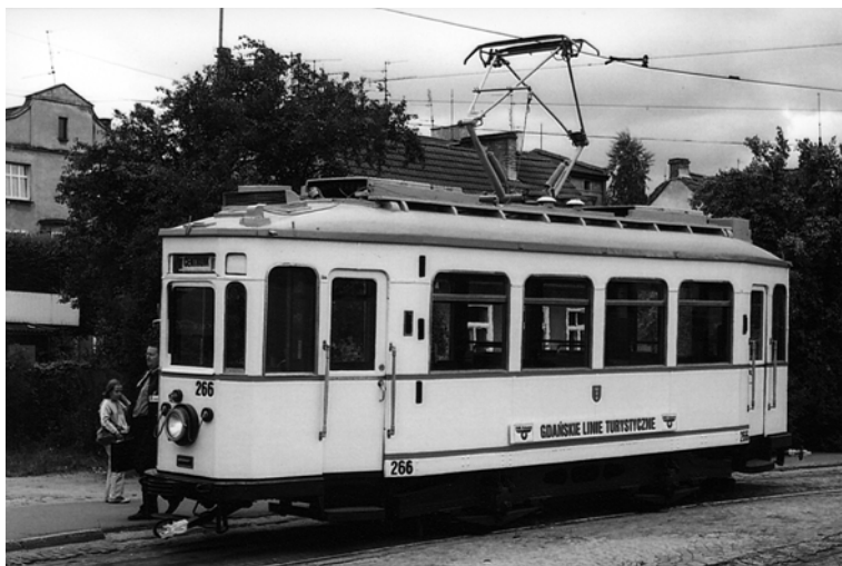
Fot. 2.22. Typowa konstrukcja tramwaju lat 20. XX wieku – Bergmann 1927 (fot. autora)
