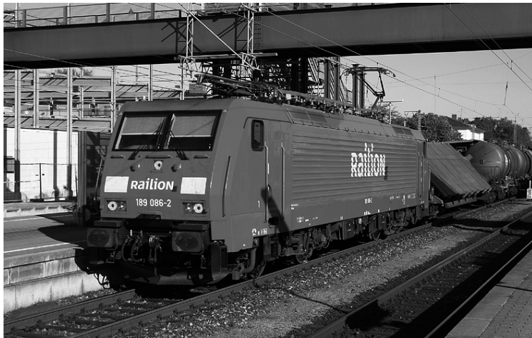
Fot. 3.11. Nowoczesna lokomotywa czterosystemowa typu ES 64 F4 (fot. S. Terfloth)
