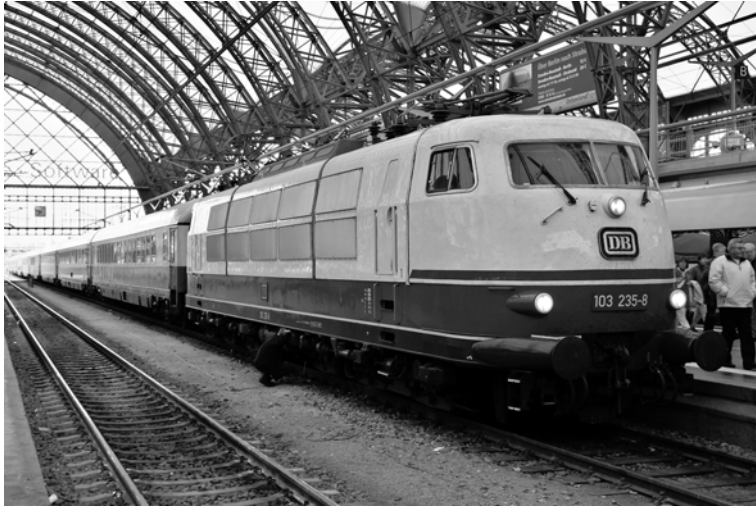
Fot. 2.32. Pierwsza lokomotywa o prędkości maksymalnej 200 km/h (fot. S. Terfloth)
