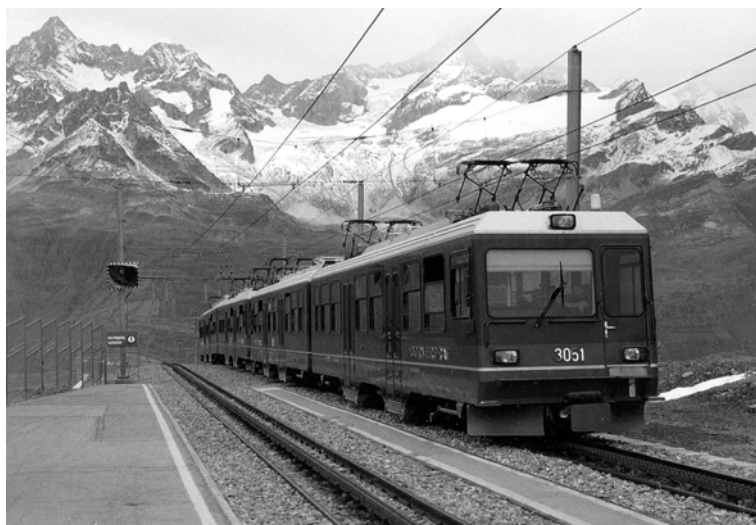
Fot. 3.1. Zespół trakcyjny zasilany trójfazowo na linii Zermatt-Gornergrat (fot. autora)
