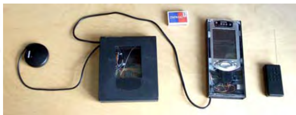
Fot. 5. Prototyp systemu nawigacji dla osób niewidomych (praca doktorska, Sz. Ceranka, 2006) Fot. Sz. Ceranka
