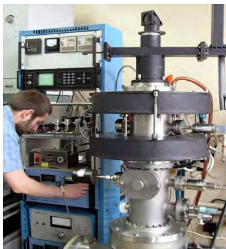
Fot. 2. System PECVD do badania procesów wytwarzania warstw DLC (diamond like carbon)
