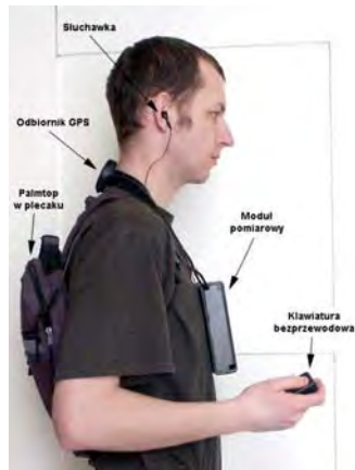
Fot. 5. Prototyp systemu nawigacji dla osób niewidomych (praca doktorska, Sz. Ceranka, 2006) Fot. Sz. Ceranka
