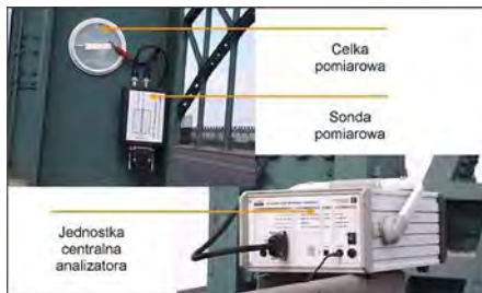
Fot. 4. Analizator spektroskopii wysokoimpedancyjnej HIADAC w badaniach terenowych
