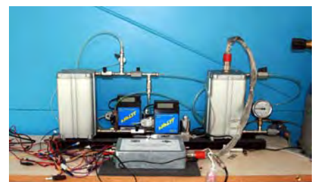
Fot. 5. Stanowisko do badania zjawisk fluktuacyjnych w rezystancyjnych sensorach gazu
