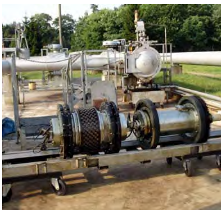
Fot. 1. Robot inspekcyjny do badania stanu technicznego rurociągów (fot. P. Raczyński)
