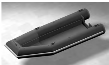
Rys. 1. Projekt jednostki w całości wykonanej z polietylenu (WORKER – dł. 4 m). Rys. autor
