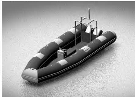
Rys. 2. Projekt jednostki w całości wykonanej z polietylenu (WORKER 2 – dł. 6,5 m). Rys. autor
