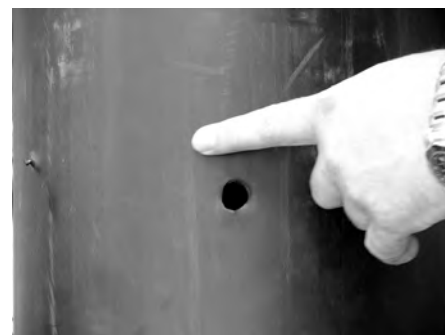
Fot. 5. Próby strzeleckie pływaków wypełnionych pianką polipropylenową. Fot. autor
