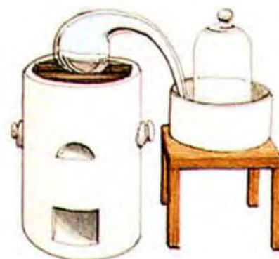
Aparat używany przez Lavoisiera do badania spalania. Kompendium. Wiedza w pigułce. Firma Księgarska Jacek i Krzysztof Olesiejuk 2005
