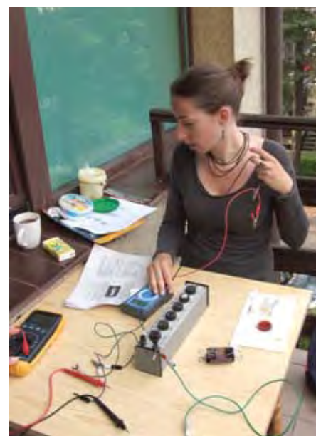
Studentka V roku Ewa Rusin wykonuje pomiary sprawności ogniwa fotowoltaicznego
