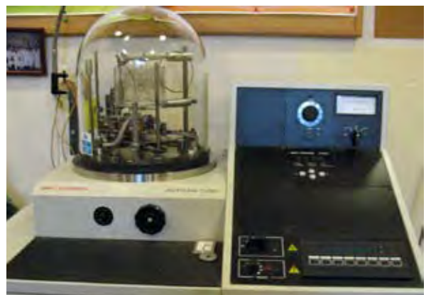
Nowoczesna próżniowa napyłarka z pompą turbo molekularną Fot. Iwona Kuzborska
