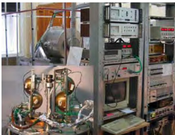
Fot. 1. Elektrostatyczny spektrometr elektronowy Zespołu Spektroskopii Elektronowej WFTiMS. Z lewej strony u dołu zamieszczono zdjęcie układu spektrometrycznego
