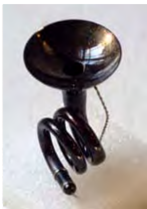
Kanałowy powielacz elektronów – jeden elektron wpadający do powielacza jest powielany dając na wyjściu 100 milionów elektronów Fot. Jan Ryszard Barczyński
