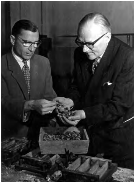
Profesor z asystentem Stanisławem Nagrodzkim sprawdzają uziarnienie kruszywa do wykonania próbek laboratoryjnych
