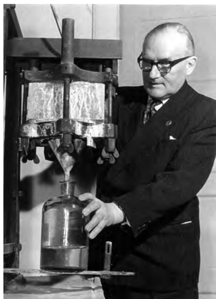
Profesor kontroluje badanie wodoszczelności betonu
