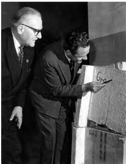
Profesor z Tadeuszem Szulczyńskim analizują wielkość i rozmieszczenie rys w zbadanym elemencie tarczowym
