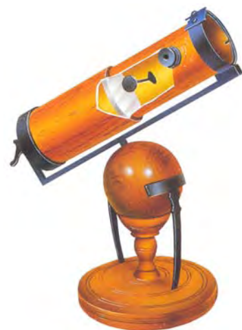
Teleskop zwierciadlany Newtona; źródło: Kompendium. Wiedza w pigułce. Firma Księgarska Jacek i Krzysztof Olesiejuk 2005
