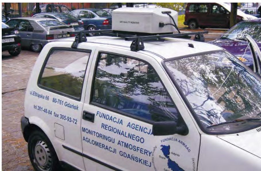
Rys. 1. Niezależna jednostka pomiarowa montowana na pojazdach
