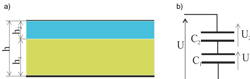
Rys. 6.9. Przekrój kondensatora płaskiego (a) i jego model obwodowy (b)
