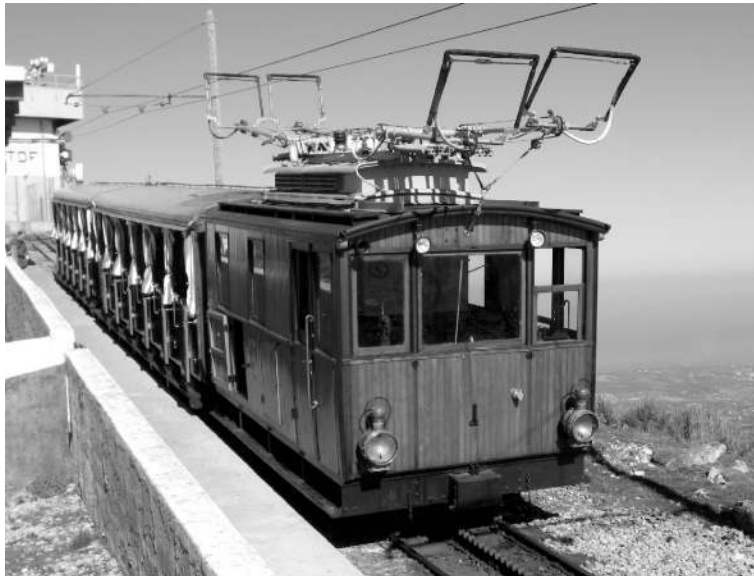
Fot. 5.11. Lokomotywa z odbierakiem ramkowym podwójnym [96]
