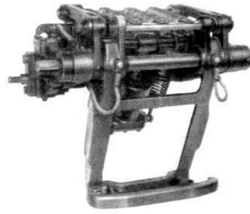
Fot. 5.34. Odbierak łyżwowy dostosowany do bocznego odbioru prądu ( S-Bahn Hamburg) [22]
