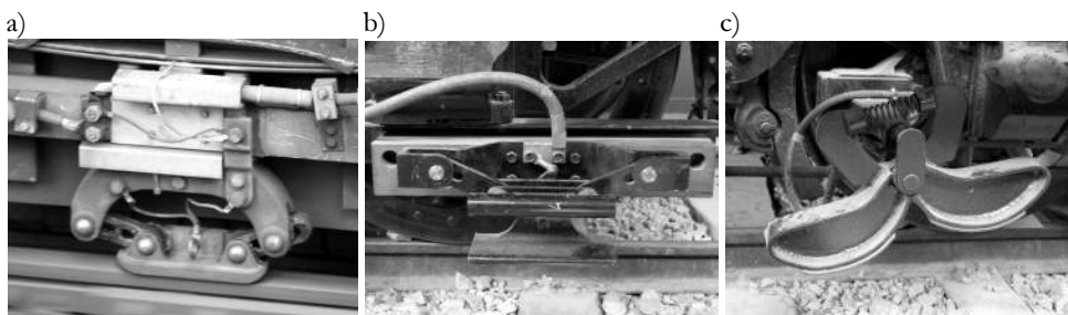
Fot. 5.31. Odbieraki łyżwowe dostosowane do górnego odbioru prądu, gdzie: a, b) odbieraki z dociskiem grawitacyjnym; c) odbierak z dociskiem sprężynowym (fot. a: D. Schwen; b, c: autora)
