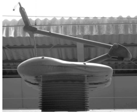
Fot. 5.25. Odbierak jednoramienny PS207 o ograniczonym zakresie ruchu pionowego (fot. O. Chikuwa)
