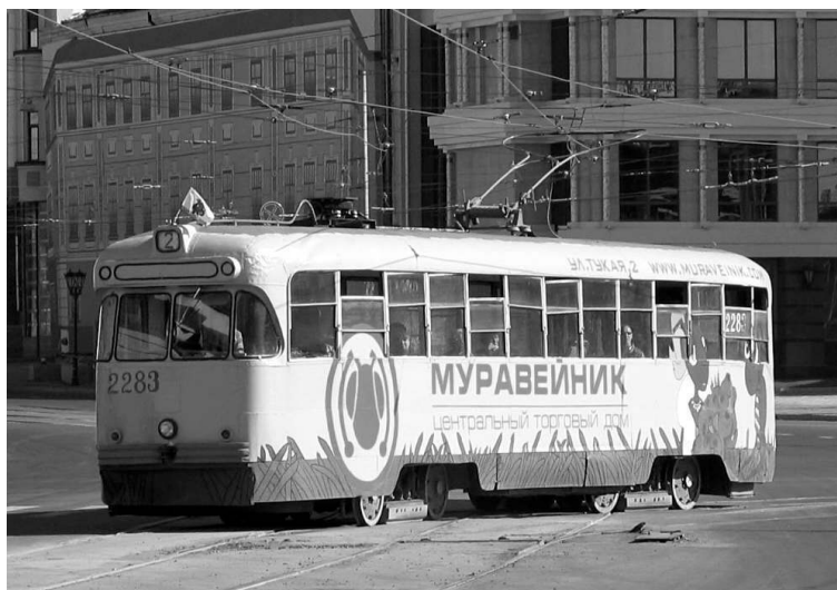
Fot. 5.8. Tramwaj PB3-6 z odbierakiem pałkowym w Kazaniu (fot. A. Surikov)
