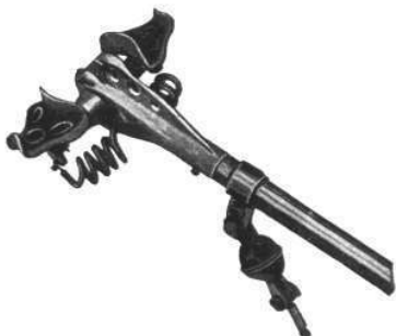
Fot. 5.6. Głowica odbieraka drążkowego podwójnego – system Schiemann'a [4]
