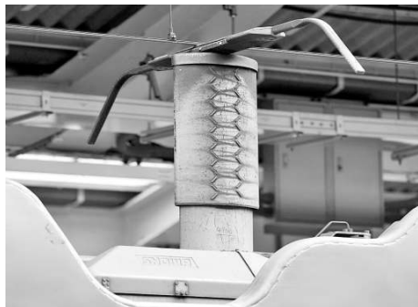
Fot. 5.28. Odbierak teleskopowy WPS204 (fot. „Tennen-Gas”)
