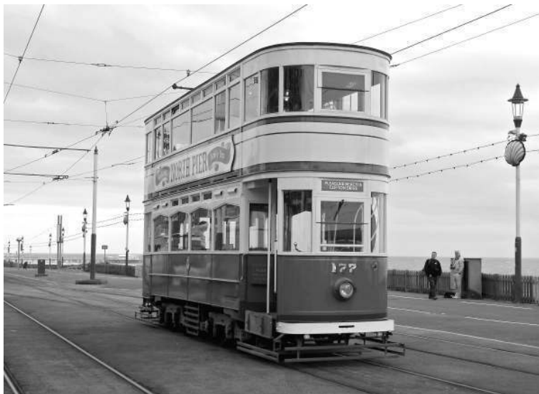
Fot. 5.3. Tramwaj w Blackpool z odbierakiem drążkowym krążkowym (fot. M. Jobling)
