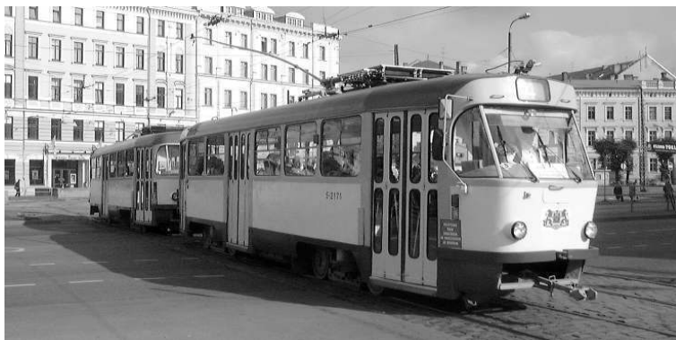
Fot. 5.5. Tramwaj w Rydze z odbierakiem drążkowym łyżkowym (fot. P. Van den Bossche)
