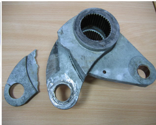
Rys.4.4. Awaria wyłącznika HPL przy dławiku sieciowym po stronie polskiej wg [źródła własne]
