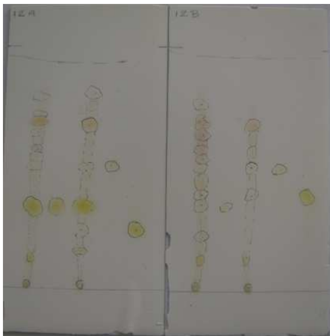
Rys. 7. Chromatogram cienkowarstwowy w świetle widzialnym
