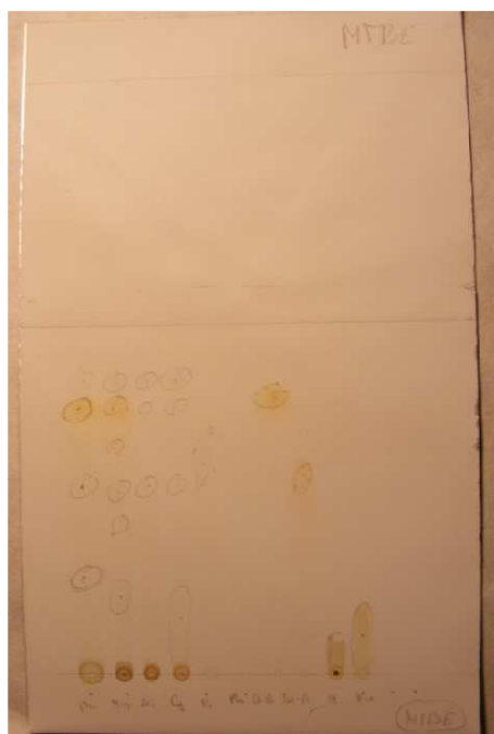
Rys.6. Chromatogram cienkowarstwowy w świetle widzialnym
