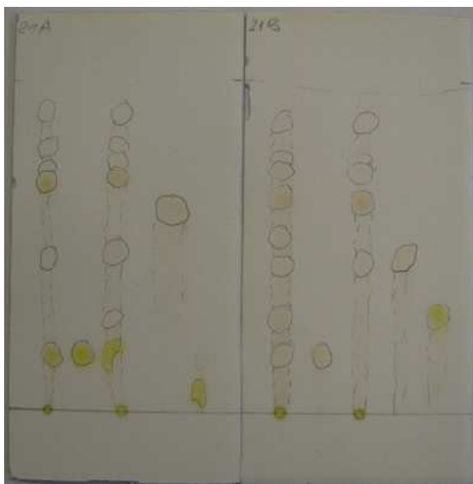
Rys. 4. Chromatogram cienkowiarskowy w świetle widzialnym
