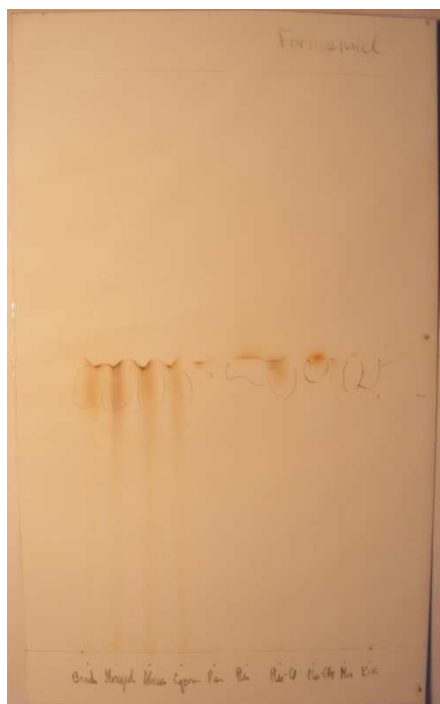
Rys.7. Chromatogram cienkowarstwowy w świetle widzialnym
