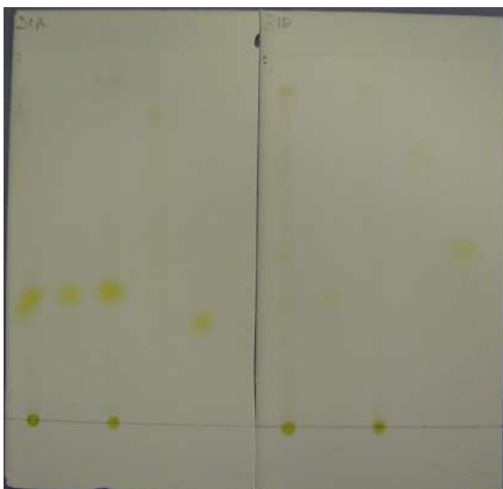
Rys. 5. Chromatogram cienkowarstwowy w świetle widzialnym
