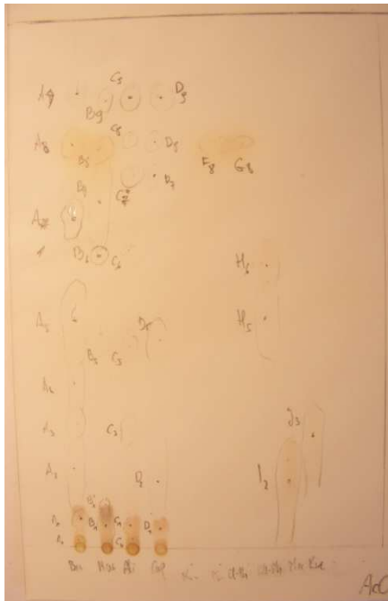
Rys.5. Chromatogram cienkowarstwowy w świetle widzialnym
