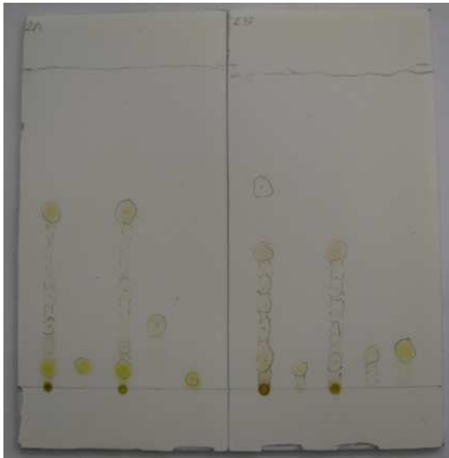
Rys. 2. Chromatogram cienkowarstwowy w świetle widzialnym
