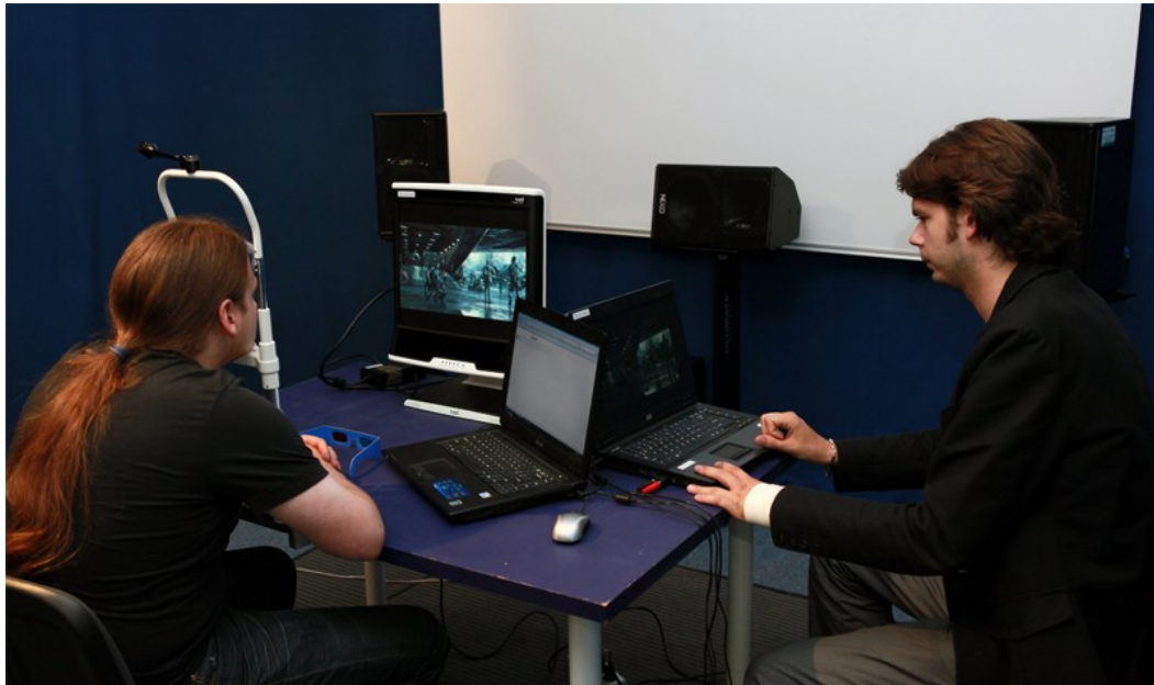
Rys. E.1 Stanowisko badawcze z wykorzystaniem systemu Tobii T60
