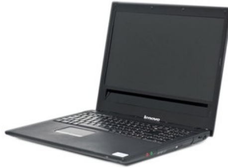
Rys. 4.6 Prototypowy laptop firmy Lenovo z wbudowanym systemem śledzenia wzroku [178]
