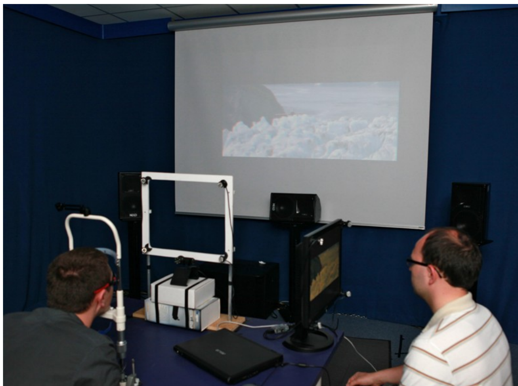
Rys. E.4 Stanowisko badawcze z wykorzystaniem systemu Cyber-Oko pracującego w trybie wyświetlania obrazu na ekranie projektora
