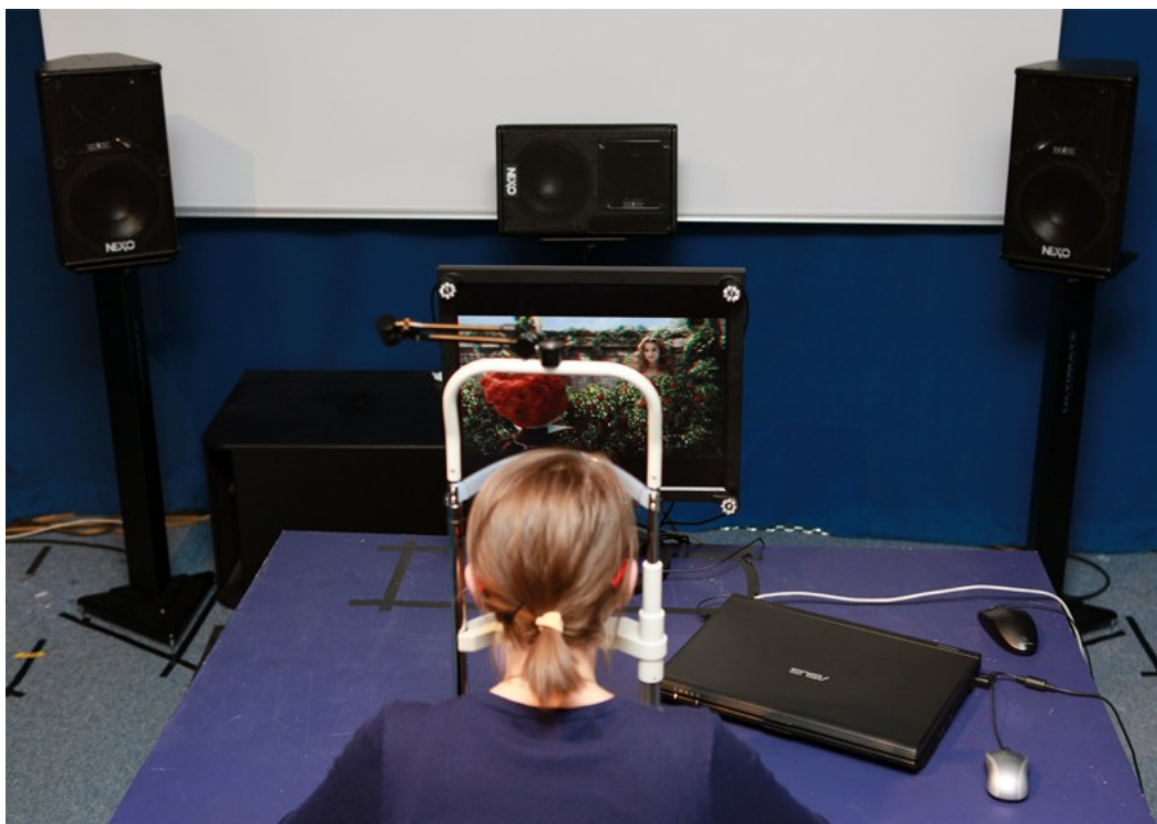
Rys. E.3 Stanowisko badawcze z wykorzystaniem systemu Cyber-Oko pracującego w trybie normalnym
