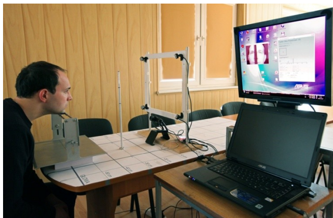
Rys. 4.18 Konfiguracja stanowiska badawczego wykorzystującego ramkę imitującą ekran monitora Cyber-Oka
