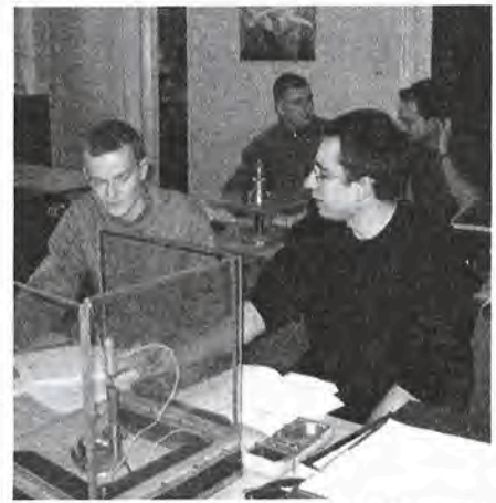
Pomiar strat ciepła w zależności od różnicy temperatur (fot. Barbara Kusz)
