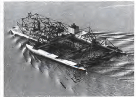
Badania oporu morskiego zestawu pchanego
