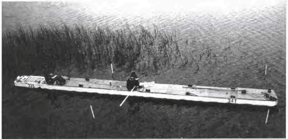
Badania pokonywania zakola przez model zestawu Bawół
