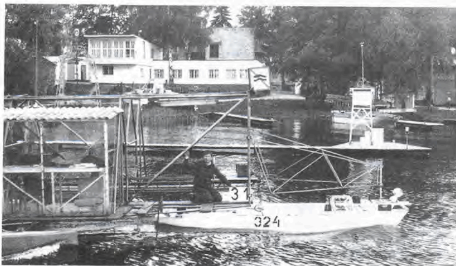
Badanie układu fali dla katamaranu
