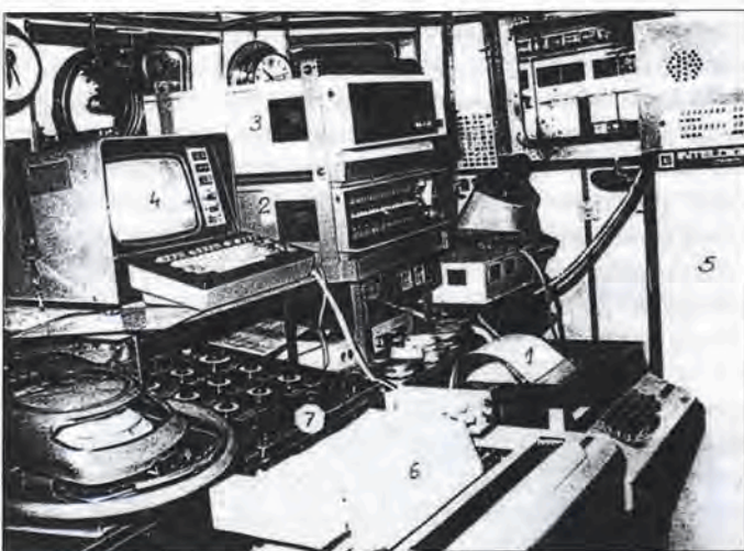
Kompleksowa automatyzacja okrętu „proj.918” w technice komputerowej. Zestaw komputerowy w sterówce okrętu: 1 – teletype; 2 – minikomputer „K-202”; 3 – dodatkowa pamięć komputera (zewnętrzna); 4 – monitor ekranowy; 5 – kanał automatyki; 6 – drukarka; 7 – pulpity sterowania zautomatyzowaną siłownią z pominięciem minikomputera
