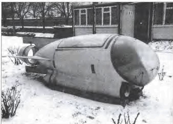
Niewielki pojazd podwodny typu mokrego, dla pletwonurka (w eksploatacji jeszcze w 1999 r.)
