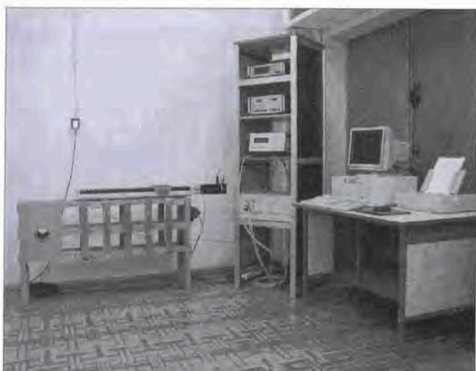
Stanowisko do badań serwonapędów pozycjonujących w laboratorium Katedry
