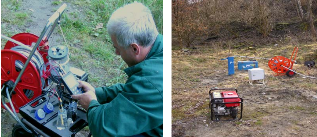
Rysunek 14. Przepompowanie piezometru (rys. lewy) oraz sprzęt używany do pobierania próbek wód podziemnych (rys. prawy) [134].
