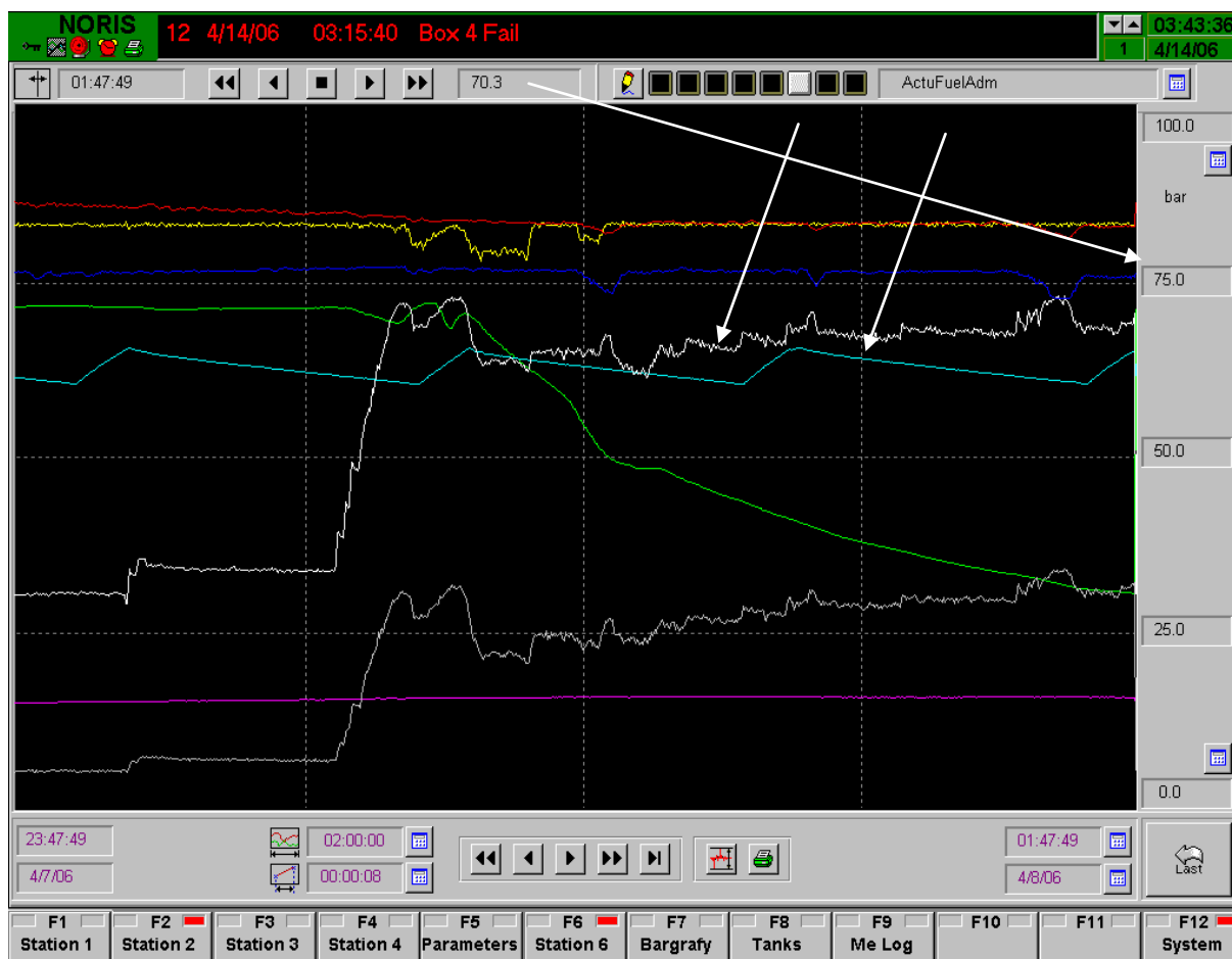
Rys. 2.3 Wykres trendów mierzonych parametrów pracy wyszczególnionych układów roboczych, na wykresie widoczny jest parametr Actu Fuel Adm z jego wartościami chwilowymi, oraz 7 innych wybranych parametrów (reprezentowane wykresy różnymi barwami) - NORIS [100]
