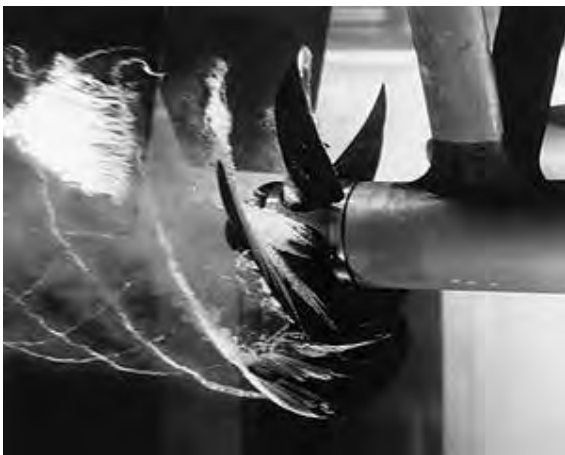
Rys. nr. 4.8 Wstęgi wirowe strugi wody spływającej z płatów śruby podczas jej pracy [105].
