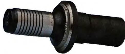
Rys. nr.4.9 Korozyjne i mechaniczne uszkodzenie przylgni zaworu zwrotnego. [zdjęcie własne].
