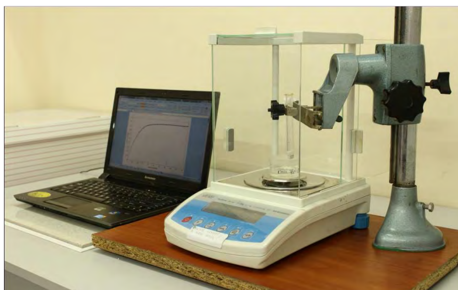
Rysunek 35. Układ badawczy do pomiarów metodą wzniesienia kapilarnego [fot. D. Hołownia – Kędzia]
