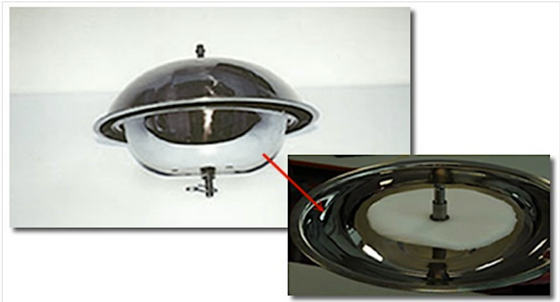
Rysunek 15. Schemat oraz zdjęcia dozymetru pasywnego z krążkiem z pianki poliuretanowej
