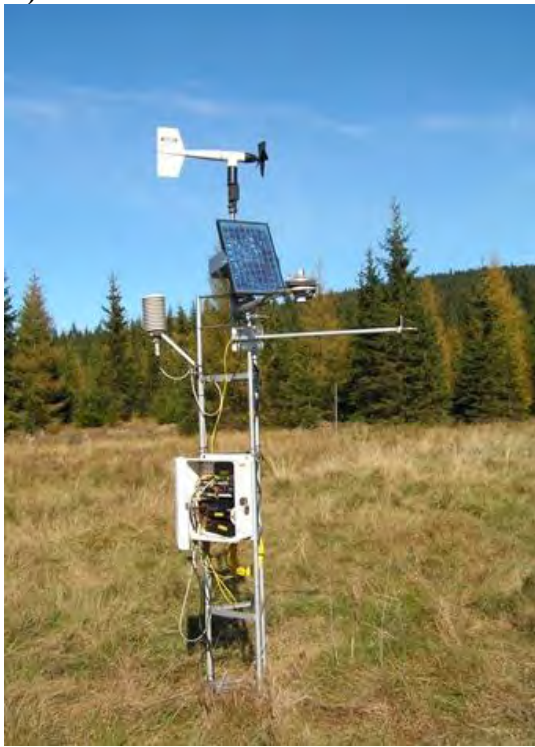
Rysunek 35. A) Automatyczna stacja meteorologiczna, B) System do pomiaru temperatury śniegu na wysokości 40, 80 i 120 cm ponad gruntem (stanowisko Orle).
