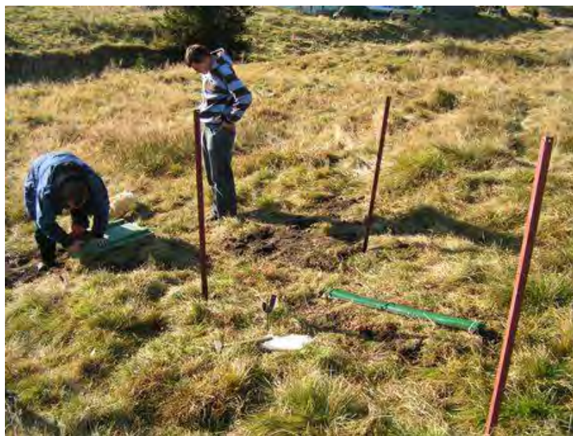
Rysunek 36. Poletko śnieżne z centralnie usytuowaną rynną oraz skrzynia z kolektorem do gromadzenia wody (stanowisko Orle).
