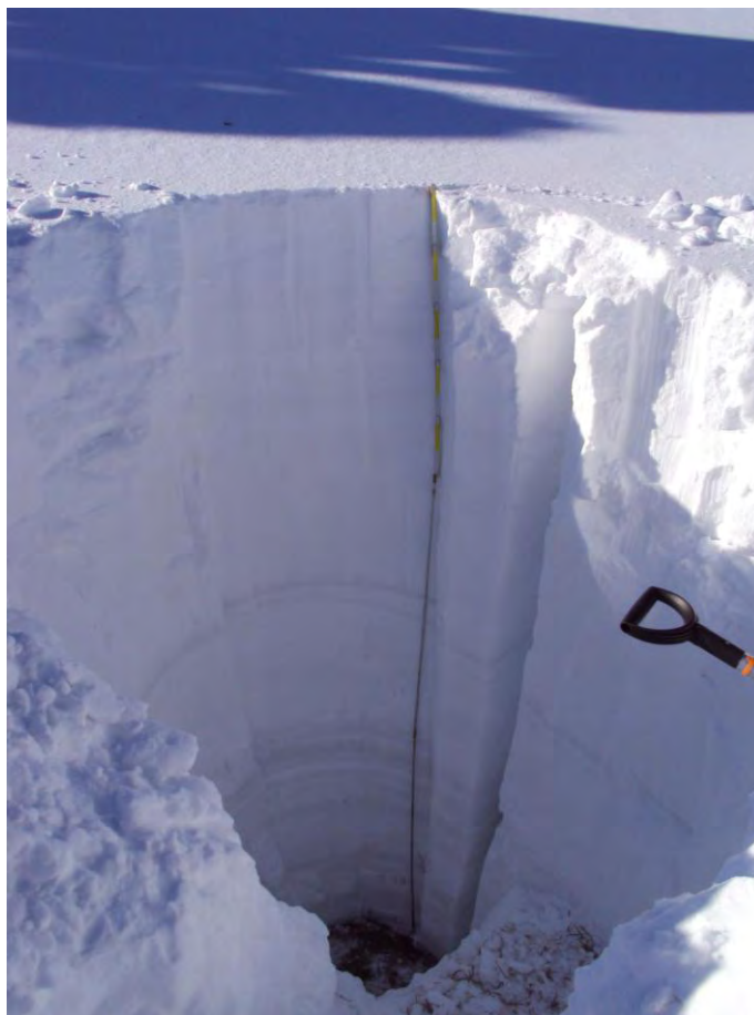
Rysunek 34. Wygląd szurfu śnieżnego przygotowanego do oznaczenia cech fizycznych śniegu.
