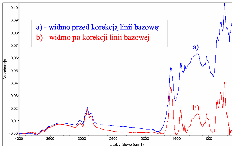
Rys. 17. Widmo pirolizatu węgla B przed dokonaniem korekcji linii bazowej (a) i po jej wykonaniu (b)
