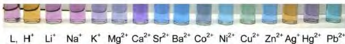
Rys. 123. Próby kolorymetryczne dla roztworów związku 6e w acetonitrylu. 112
