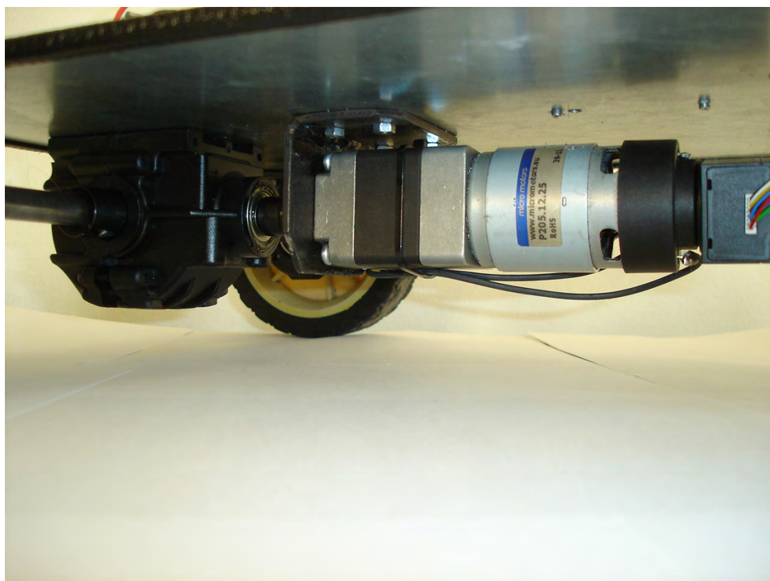
Rys. 6.7. Trójkołowa platforma mobilna (układ napędowy – motoreduktor, układ różnicowy)
