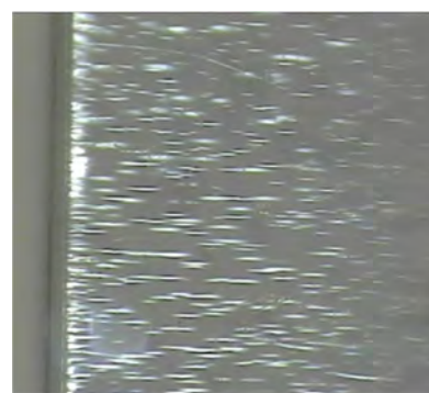
Rys. 124 Mikro spękania próbki
