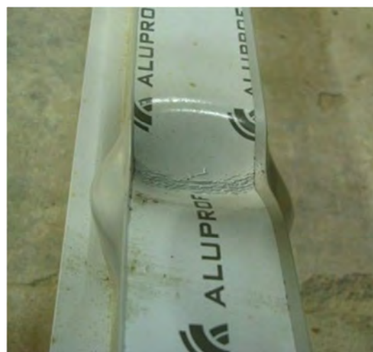
Rys. 137 Lokalne zniszczenie płatwi
