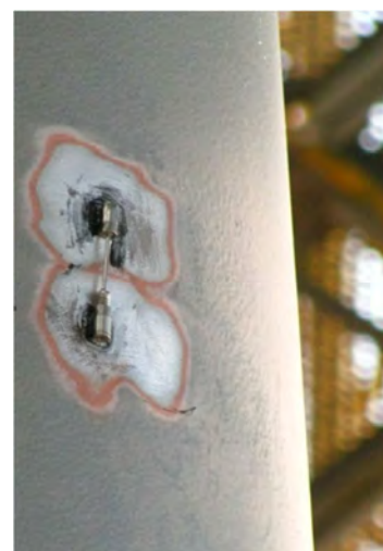
Rys. 144 Zamontowany ekstensometr strunowy
