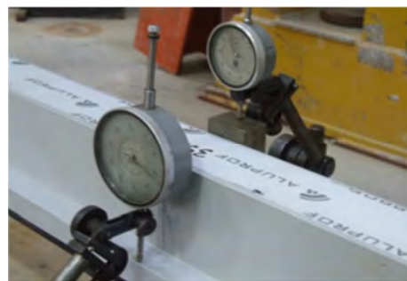
Rys. 139 Mechaniczne czujniki użyte do pomiaru ugięć
