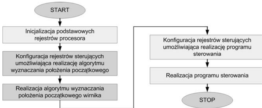
Rys. 5.5. Kolejność operacji wykonywanych po włączeniu układu
