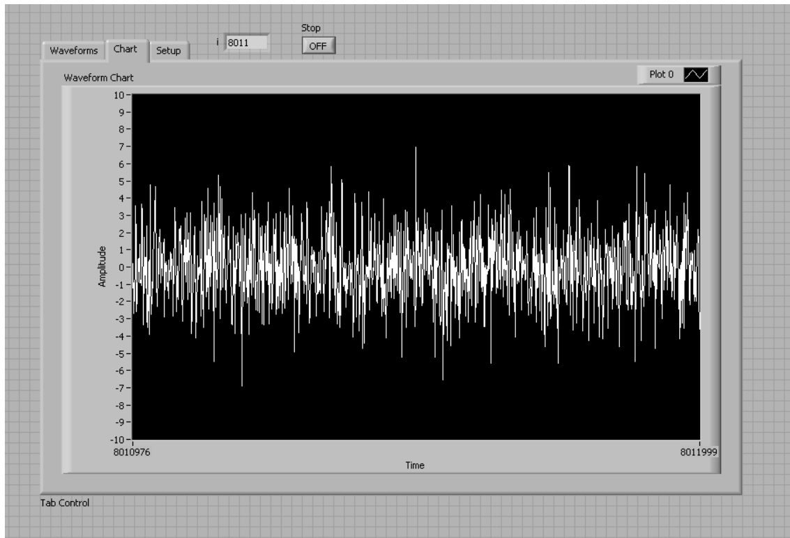
Rys. B.4. Panel czołowy przyrządu wirtualnego opracowanego w środowisku LabVIEW kontrolującego układ do pomiarów szumów w rezystancyjnych czujnikach gazów – widok podglądu rejestrowanych przebiegów czasowych
