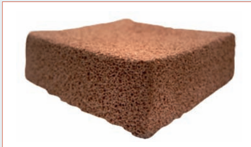
Materiał porowaty na konstrukcje pochłaniające energię
