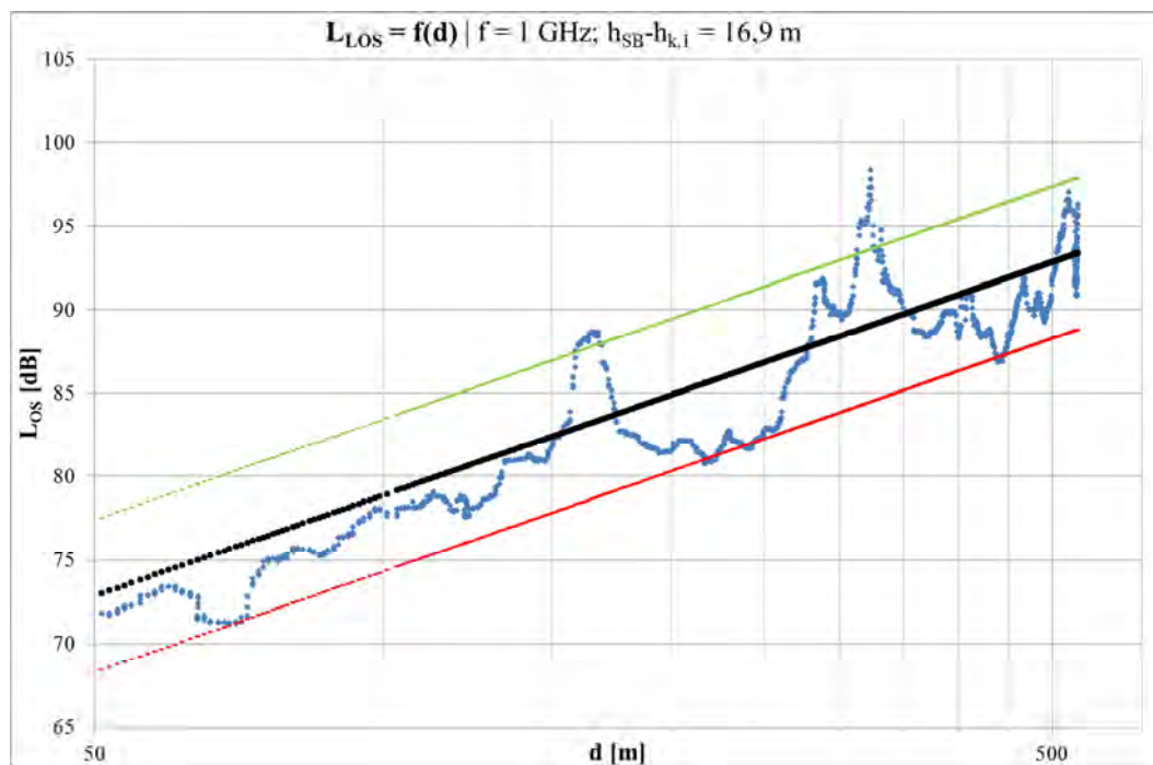
Rys. 5.10. Przykładowy wykres tłumienia propagacyjnego dla obszaru LOS – f=1\text{GHz} , h_{SB}=24\text{m} ( L_{p,LOS} – niebieski, L_{LOS} – czarny, L_{LOS}+SEE – zielony, L_{LOS}-SEE – czerwony)
