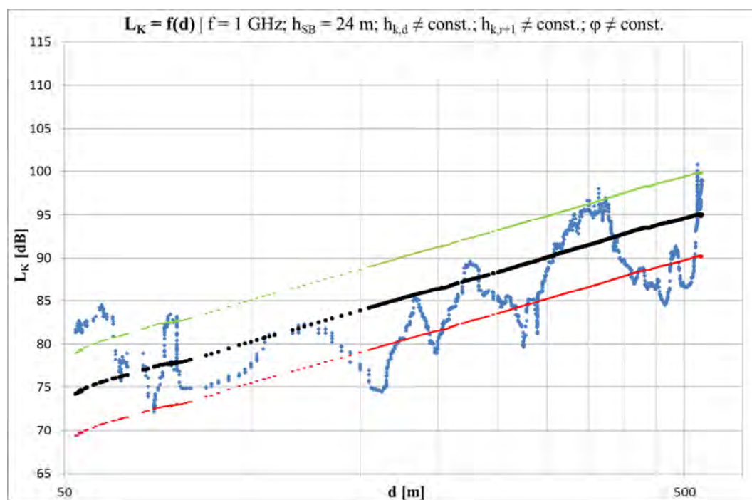
Rys. 5.22. Przykładowy wykres tłumienia propagacyjnego dla obszaru kontenerowego – f=1\text{GHz} , h_{SB}=24\text{m} ( L_{p,K} – niebieski, L_K – czarny, L_K+SEE – zielony, L_K-SEE – czerwony)
