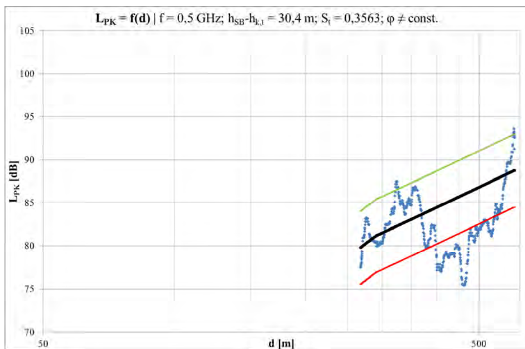
Rys. 5.32. Przykładowy wykres tłumienia propagacyjnego dla obszaru pozakontenerowego – f=0,5\text{GHz} , h_{SB}=36\text{m} ( L_{p,PK} – niebieski, L_{PK} – czarny, L_{PK}+SEE – zielony, L_{PK}-SEE – czerwony)
