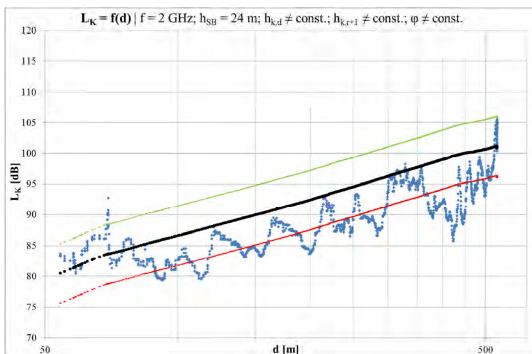
Rys. 5.25. Przykładowy wykres tłumienia propagacyjnego dla obszaru kontenerowego – f=2\text{GHz} , h_{SB}=24\text{m} ( L_{p,K} – niebieski, L_K – czarny, L_K+SEE – zielony, L_K-SEE – czerwony)
