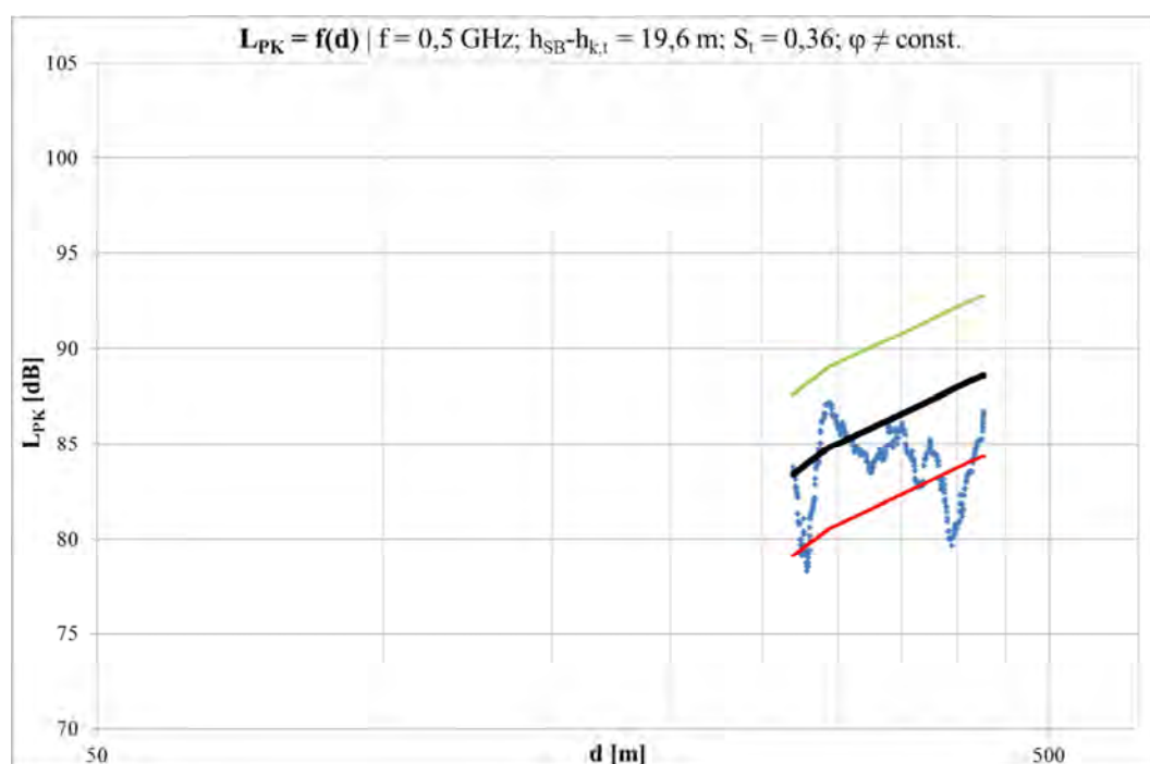
Rys. 5.31. Przykładowy wykres tłumienia propagacyjnego dla obszaru pozakontenerowego – f=0,5\text{GHz} , h_{SB}=24\text{m} ( L_{p,PK} – niebieski, L_{PK} – czarny, L_{PK}+\text{SEE} – zielony, L_{PK}-\text{SEE} – czerwony)
