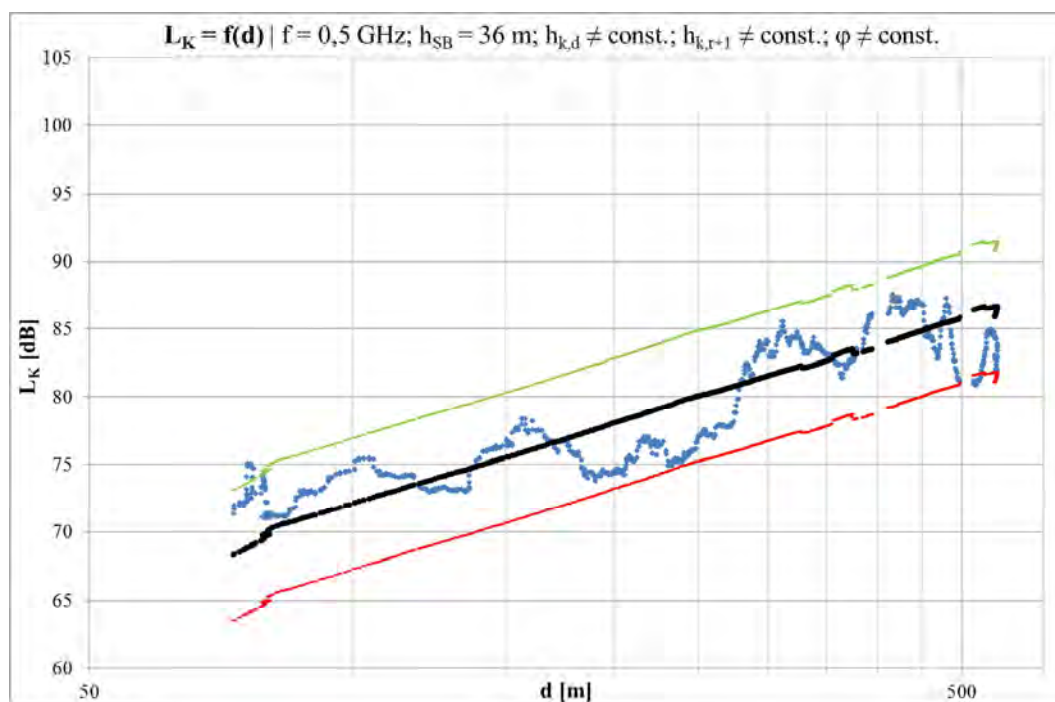
Rys. 5.20. Przykładowy wykres tłumienia propagacyjnego dla obszaru kontenerowego – f=0,5\text{GHz} , h_{SB}=36\text{m} ( L_{p,K} – niebieski, L_K – czarny, L_K+SEE – zielony, L_K-SEE – czerwony)
