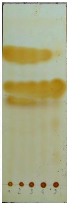
Rysunek 85. Płytkę TLC przedstawiającą postępowanie reakcji pomiędzy diselenidem 31 oraz solą malonianu dietylu 48a z dodatkami jodu; wywoływacz: jod, układ rozwijający heksan-octan etylu (7-1)
