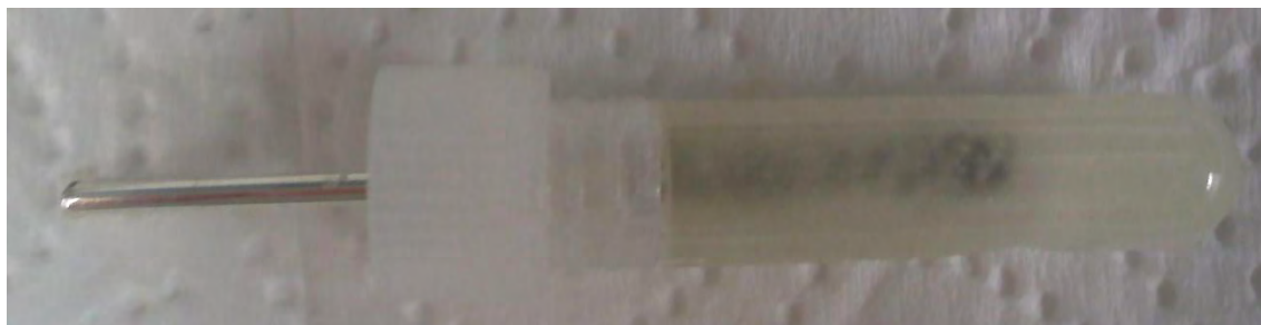
Rysunek 50. Elektroda typu MR ze zdyspergowanego KCl w polioctanie winylu
