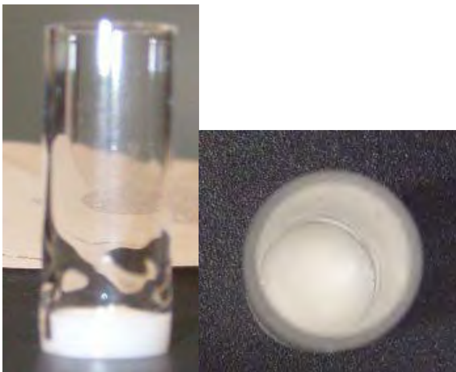
Rysunek 47. Obudowa kwarcowa do elektrody ze stopionym KCl
