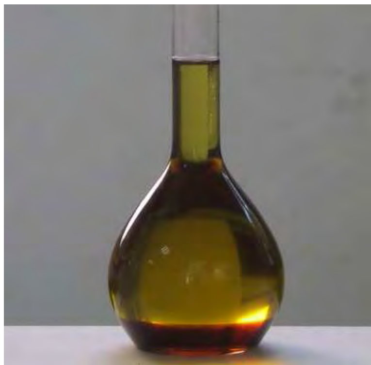
Rys. 3.1. Próbka gotowego estru metylowego oleju rzepakowego, wraz z widoczną na spodzie naczynia fazą glicerynową.
