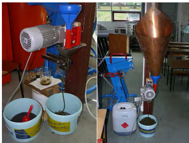
Rys. 5.7. Pracująca prasa do wytłaczania oleju rzepakowego, z dobudowaną kryzą magazynową.
