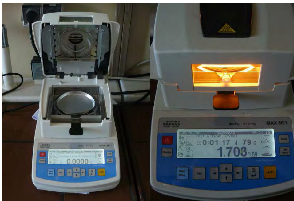
Rys. 5.4. Wagosuszarka w trybie przygotowania próbki oraz w trybie pracy.
