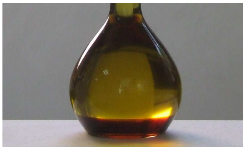
Rys. 10.1. Faza glicerynowa widoczna pod warstwą estru
