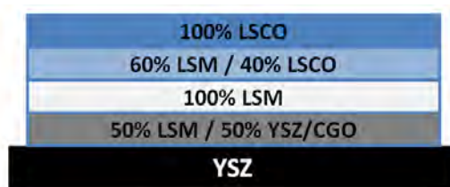
Rys.6: Schemat pólgniwa przedstawiający układ gradientowej katody na podłożu YSZ [54]
