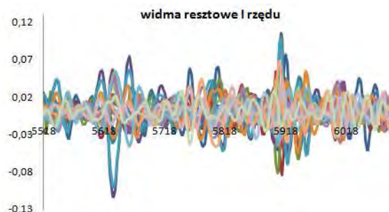
Rys.45 Widma resztowe I. rzędu dla zestawu widm po zastosowaniu transformacji do ich drugich pochodnych. Próbkom odbiegającym 11 i 4 odpowiadają linie niebieska i fioletowa
