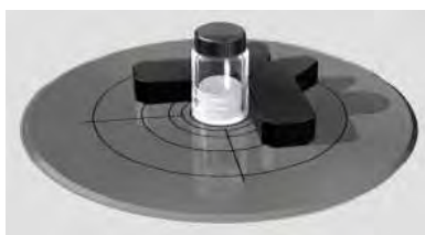
Rys13. Rysunek przedstawiający pomiar substancji stałych w trybie odbiciowym w zakresie spektroskopii bliskiej podczerwieni
