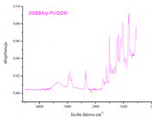
Rysunek 5.5. Widmo absorpcyjne dla układu DGEBA/ p -PU/DDM
